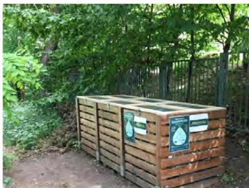
Obr. 15 Tříkomorový kompostér s víkem a ochranou proti hlodavcům (převzato z: www.ekonakup.cz )
